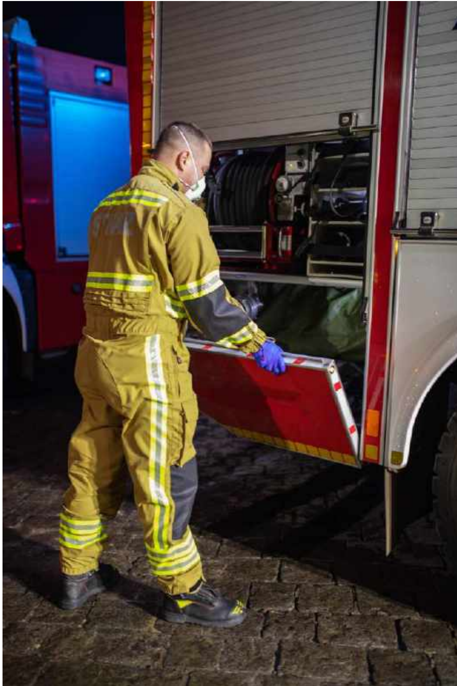
Fot. 14b: Umieszczenie worków w skrytce pojazdu pożarniczego lub w wyznaczonym do tego miejscu. Umieszczanie worków w kabinie załogi powinno być ostatecznością!
